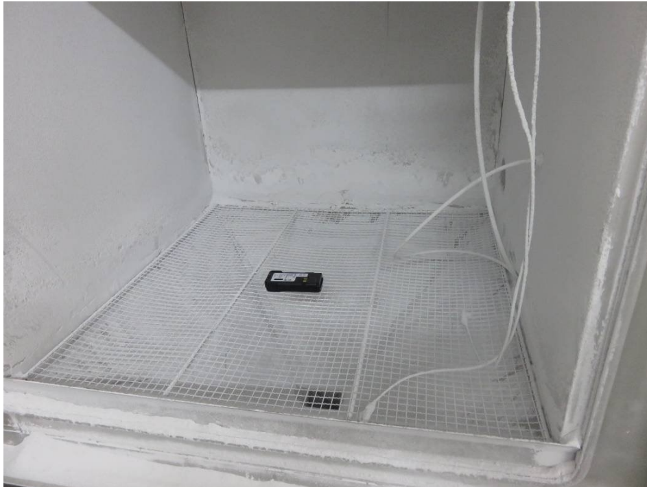
FOTO 3 - Visão antes do teste (IP6X)
