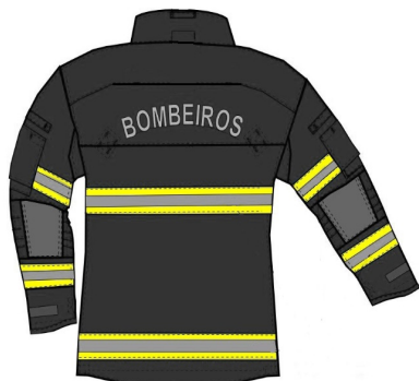
Fig. 2 - vista dorsal do casaco de proteção e alça de salvamento
