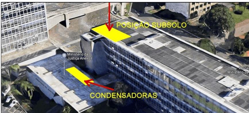
Figura 4 - Posição da sala cofre no subsolo em relação ao prédio e local de instalação das condensadoras no Anexo I
