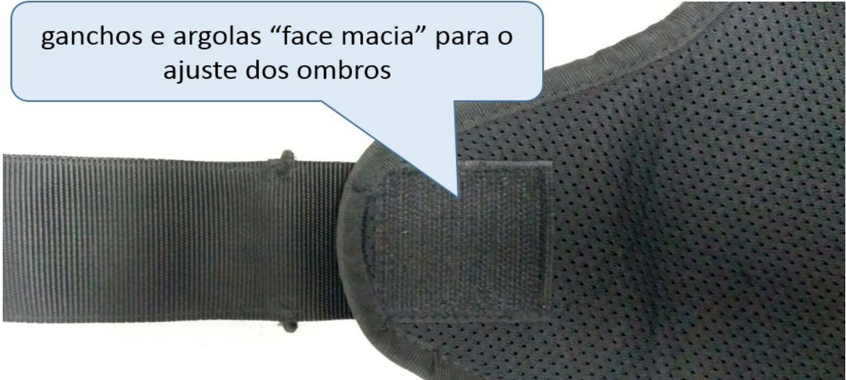
A amostra não contempla a especificação supracitada, pois a mesma está com a face rígida do sistema de ganchos e argolas em sua parte frontal.
