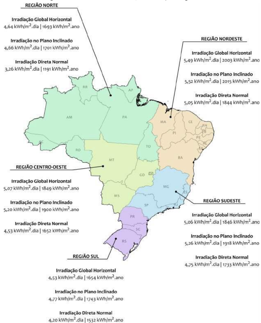
Figura 26 - Níveis de irradiação solar por região
