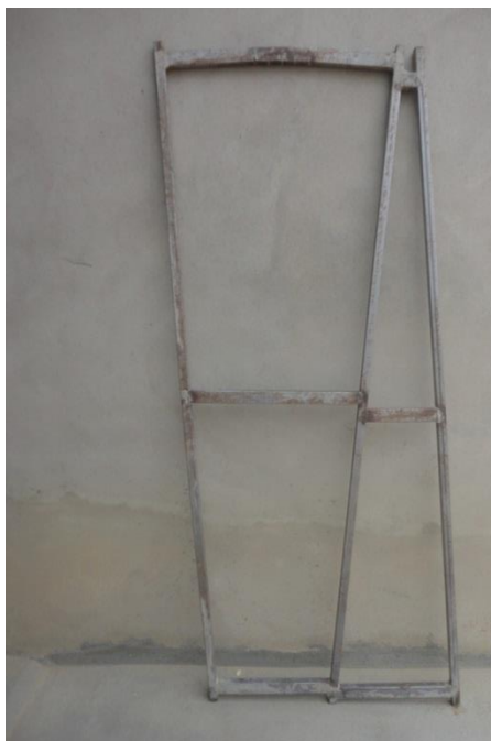
Figura 6: Fôrmas das 4 diferentes placas da cobertura da cisterna
