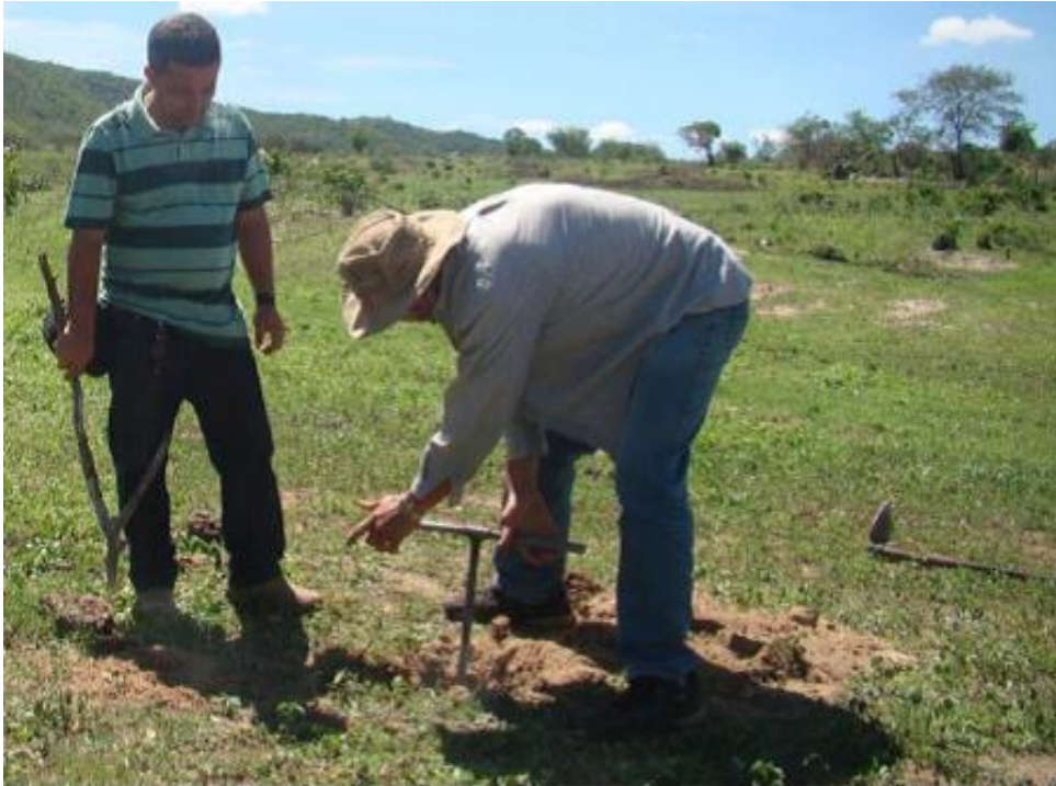
Figura 5: Locação e sondagem do solo
