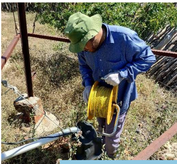
Mensuração do nível estático do ponto amostral P33, município de Floresta – PE (Eixo Leste).
