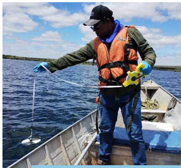
Avaliação da transparência da água, com uso do disco de Secchi, na estação amostral Q54, Reservatório Itaparica - Captação (Eixo Leste).
