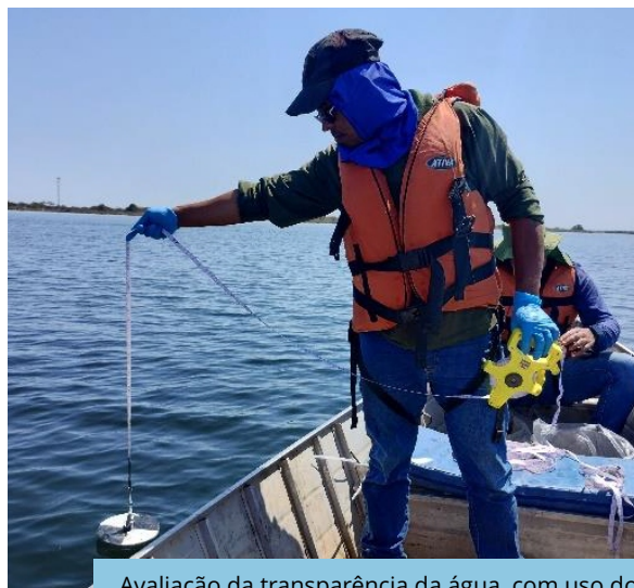
Avaliação da transparência da água, com uso do disco de Secchi, na estação amostral Q56, Reservatório Braúnas (Eixo Leste).
