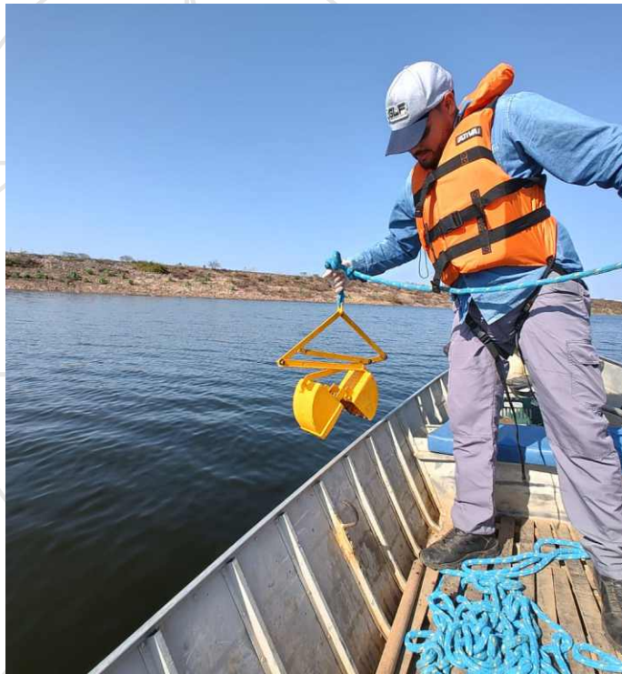
Coleta de zoobentos com a draga de Petersen no Ponto de Monitoramento PM05, Açude Capivara, município de Uiraúna/PB.
