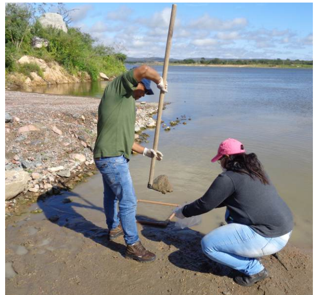
Coleta de zoobentos de margem com auxílio da enxada e do quadrado de PVC, no ponto de monitoramento I02. Arcoverde/PE.
