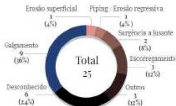
Figura 42 - Acidentes - 25 barragens - Estruturas danificadas e Mecanismo de falha principal (Fonte: Formulário complementar RSB 2023)
