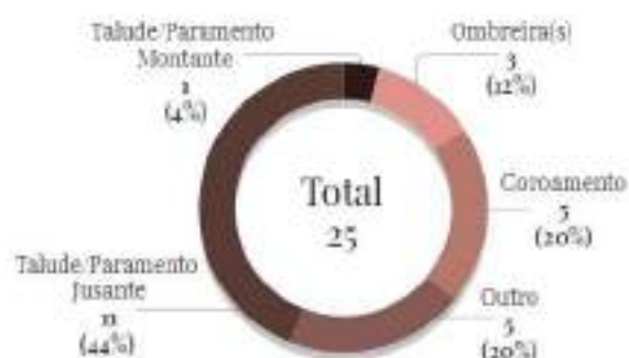
Figura 42 - Acidentes - 25 barragens - Estruturas danificadas e Mecanismo de falha principal (Fonte: Formulário complementar RSB 2023)
