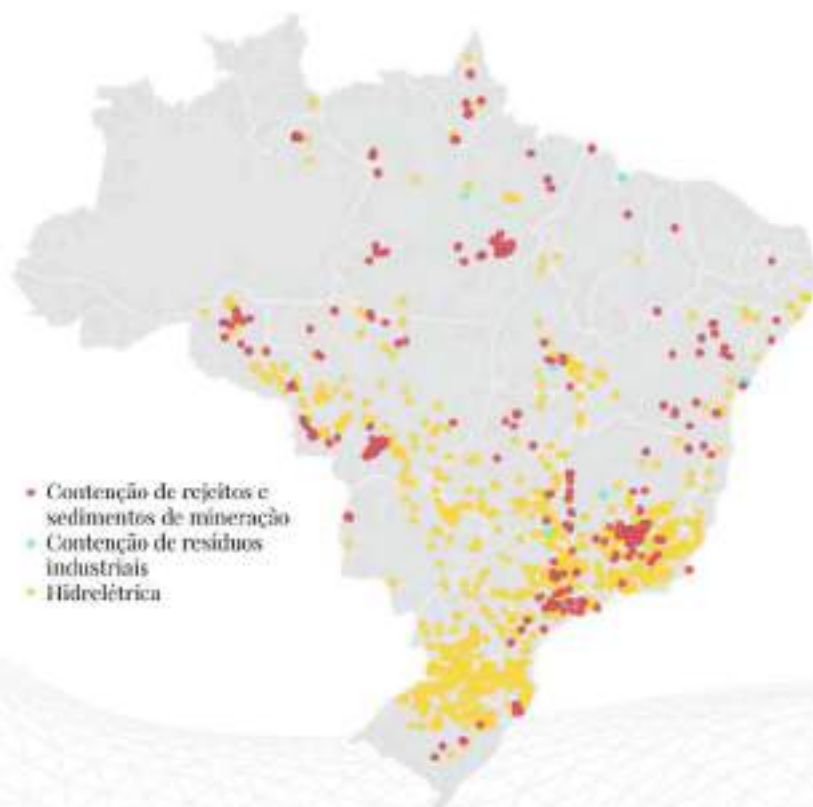
Figura 4 - SNISB - Distribuição geográfica das barragens com uso principal para disposição de Rejeitos de Mineração, disposição de Resíduos Industriais e Hidrelétricas (Fonte: SNISB, 3 de janeiro de 2024)
