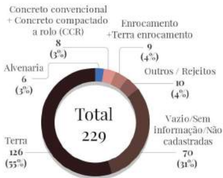
Figura 36 - Barragens prioritárias para gestão da segurança - Material do maciço (Fonte: Formulário complementar RSB 2023)
