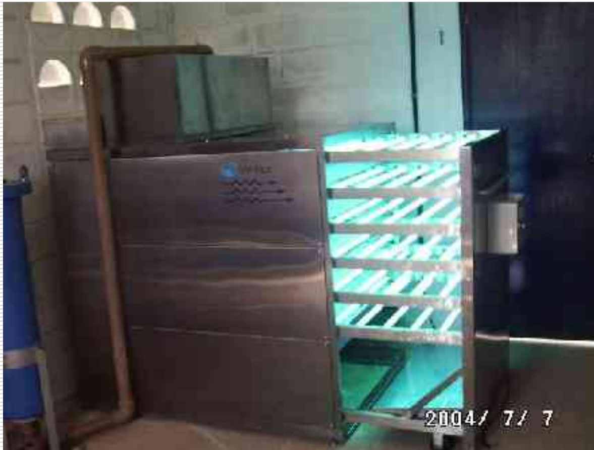
Reator UV com lâmpadas emersas
