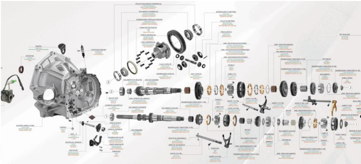
Figura 4.8.2.1.a. Principais componentes de uma caixa de transmissão manual. Fonte: Fiat Chrysler.
