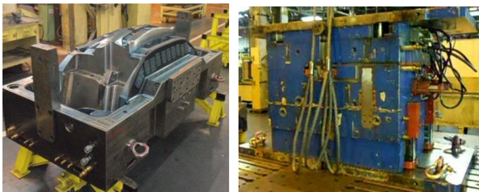
Figura 4.6.1.a. Exemplos de moldes de injeção de plástico. Fonte: General Motors do Brasil .
