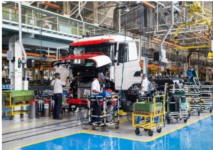
Figura 4.15.1.a. Foto ilustrativa de montagem de chassis e de carrocerias. Fonte: Scania Latin America.
