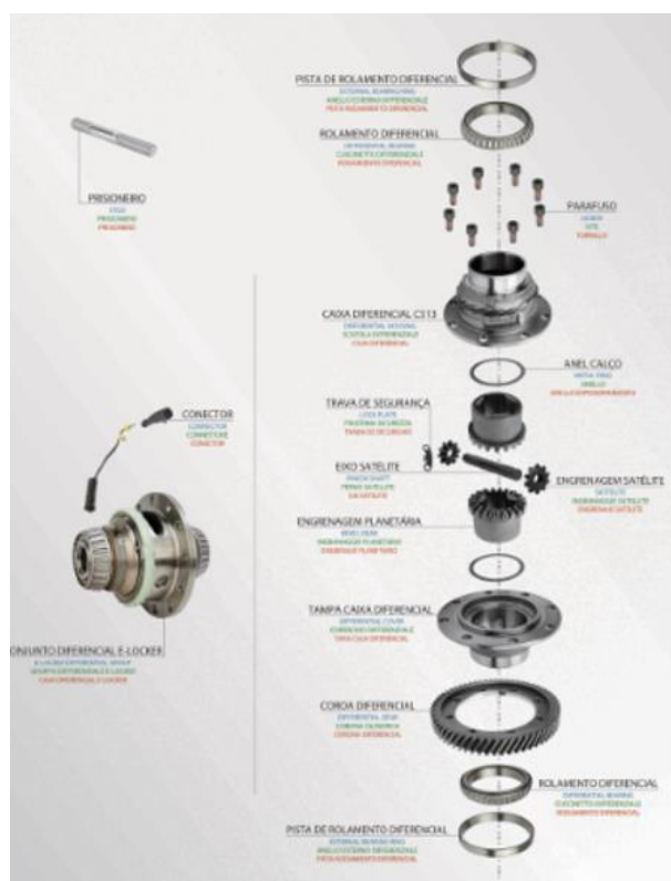
Figura 4.8.2.1.b. Principais componentes de uma caixa de transmissão manual (diferencial). Fonte: Fiat Chrysler.
