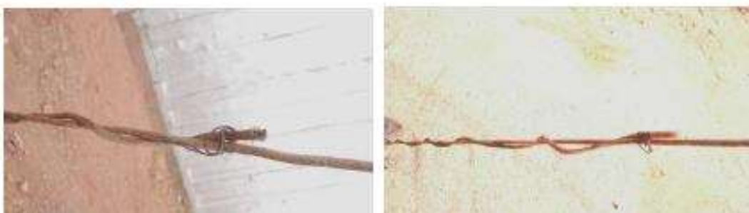
Figura 11 e 12 Cabo de aço amarrado com arame.
