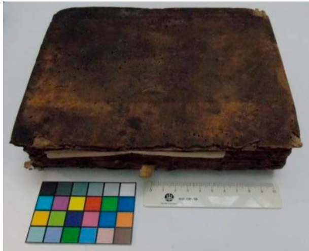
Figura 2: Exemplo de degradação, encadernação em couro com deformações, manchas variadas, enfraquecimento e deterioração
