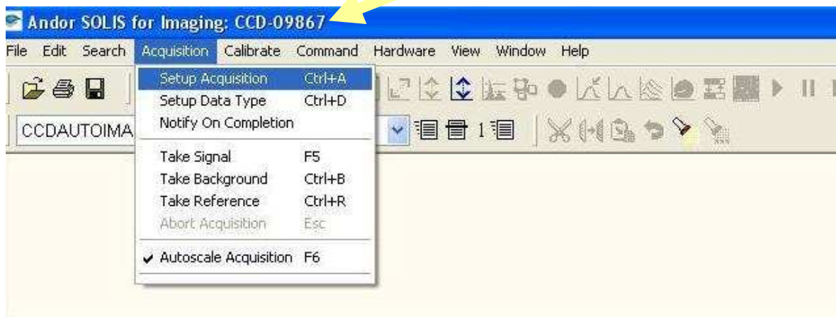
Figura 7: Para iniciar a configuração da aquisição selecione 'Acquisition' -> 'Setup Acquisition'. Note que o número de série do CCD em uso está indicado na barra de título do programa. Ele será necessário para a escolha da configuração da observação.
