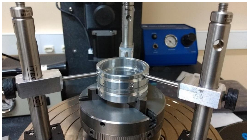
Figura 19 – Foto do conjunto de lentes montados para colagem das células (Arquivo do autor).
