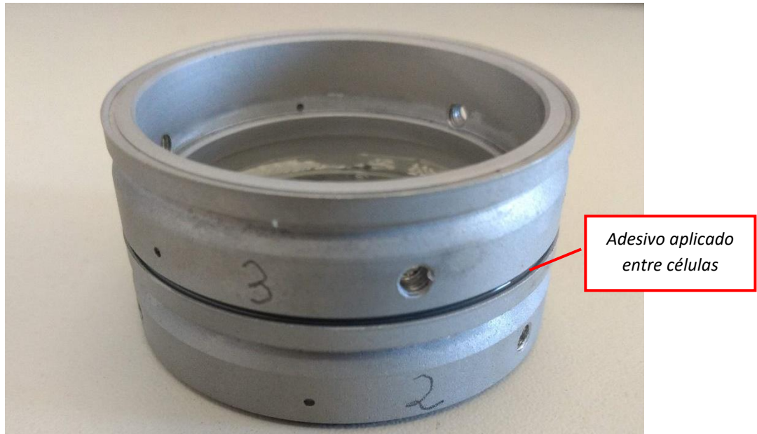
Figura 14 – Foto da sobreposição das células coladas entre si.
