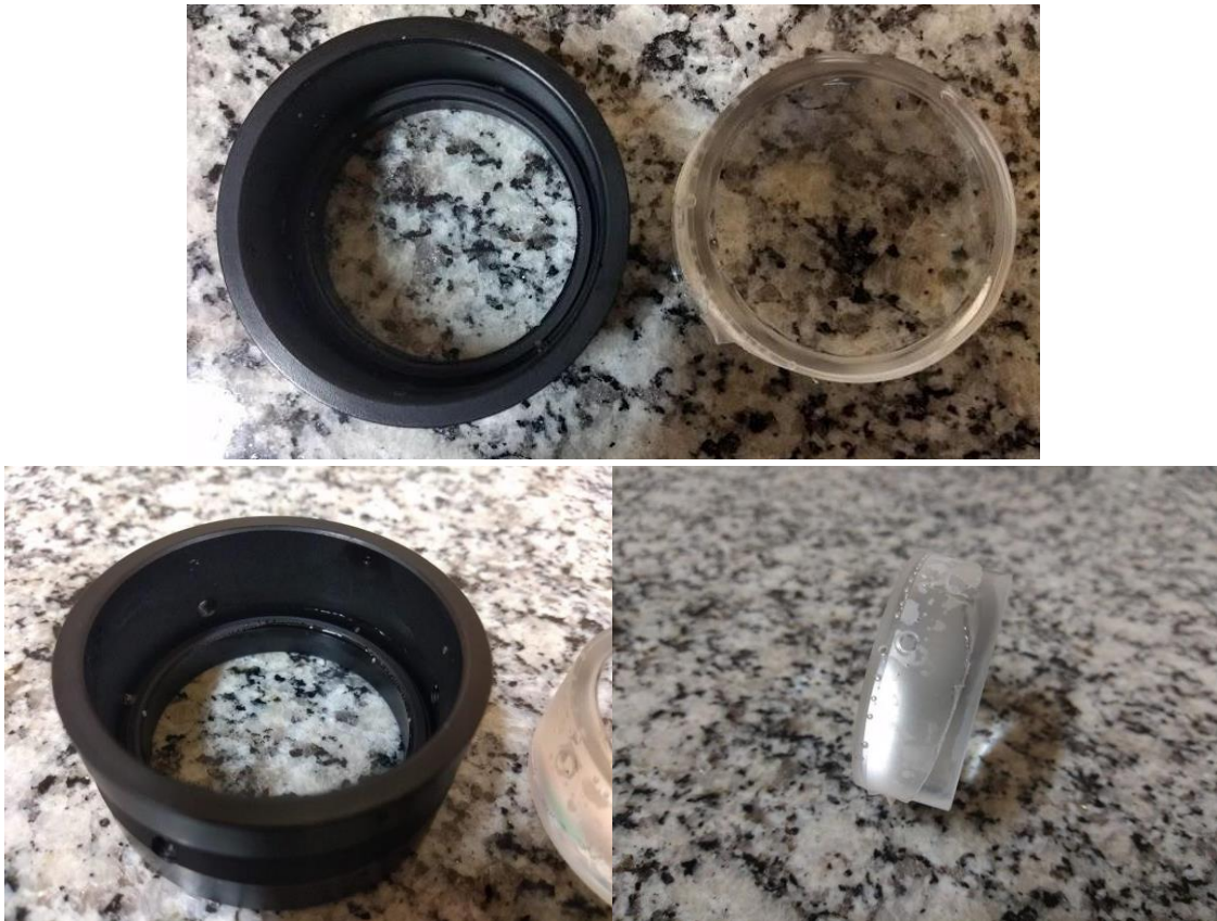
Figura 33 – Teste de ciclo térmico com sylgard 184. O adesivo se manteve na lente mas não houve aderência no metal.
