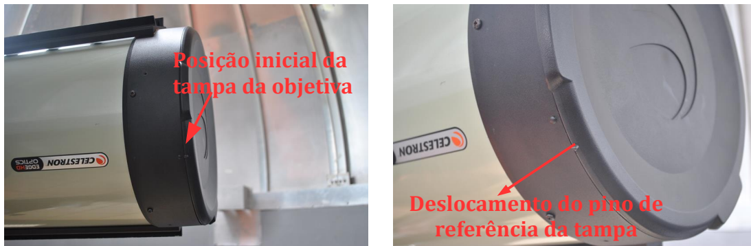
Figura 08 – A foto esquerda mostra o alinhamento dos pinos de referência (da tampa e do tubo) na posição inicial da tampa de proteção da objetiva. À direita, posição final destes após fricção no sentido anti-horário.
