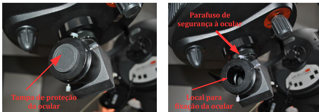
Figura 09 – À esquerda, tampa de proteção do local de fixação da ocular. Na foto à direita, mecanismo de fixação da ocular.
