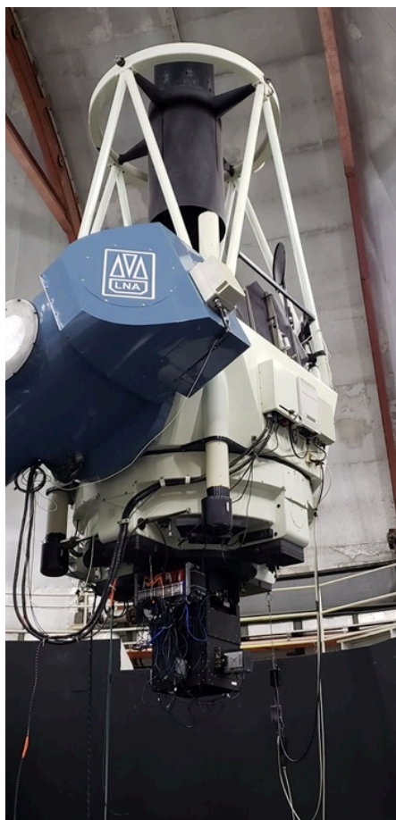
Figura 1 - SPARC4 montada no telescópio 1,6 m do OPD. Foto tirada em 04 de novembro de 2022 logo após a primeira montagem do instrumento no telescópio.
