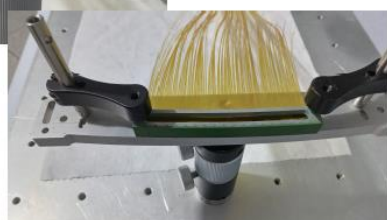
Protótipo da fenda de fibras do MOSAIC contendo duas curvaturas e ângulos de posicionamento individuais para cada fibra.
