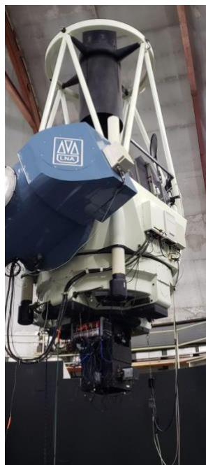
Figura 1 - SPARC4 montada no telescópio 1,6 m do OPD. Foto tirada em 04 de novembro de 2022 logo após a primeira montagem do instrumento no telescópio.
