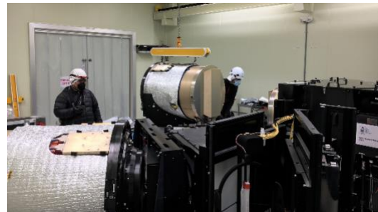
Subsistemas, câmeras e detectores sendo montados sobre a bancada ótica
