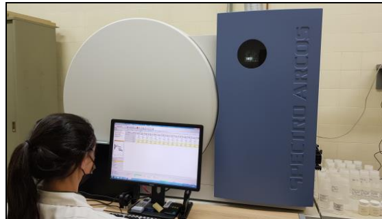
ICP ótico (análise de metais).
