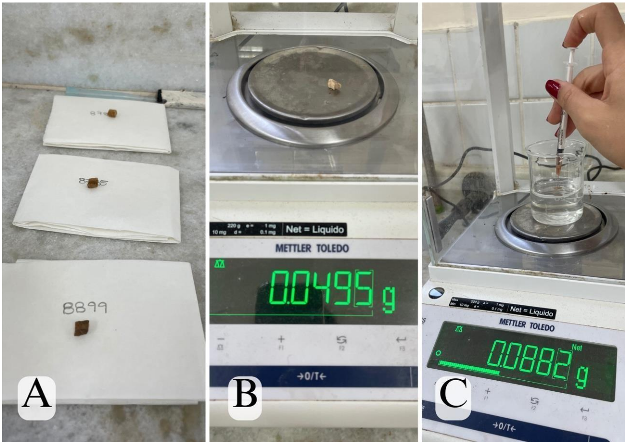
Figura 1. A - Corpo de prova das amostras; B - Pesagem de amostra seca; C - Imersão da amostra em água.
