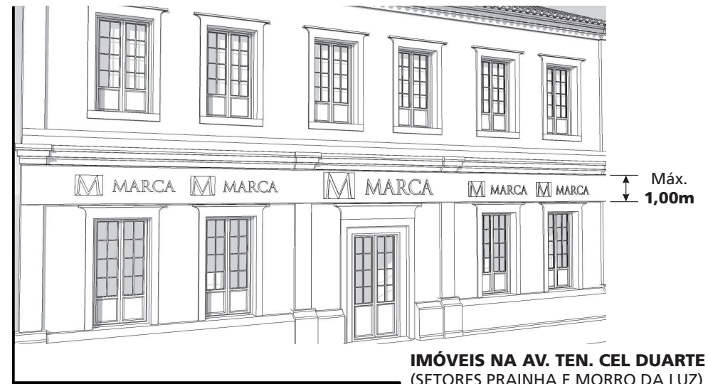
ANÚNCIO SOBRE A ALVENARIA DA FACHADA
