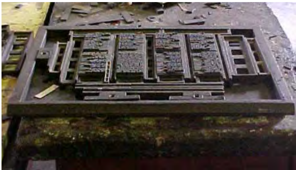
Figura 7: Matriz do texto para máquina de impressão
