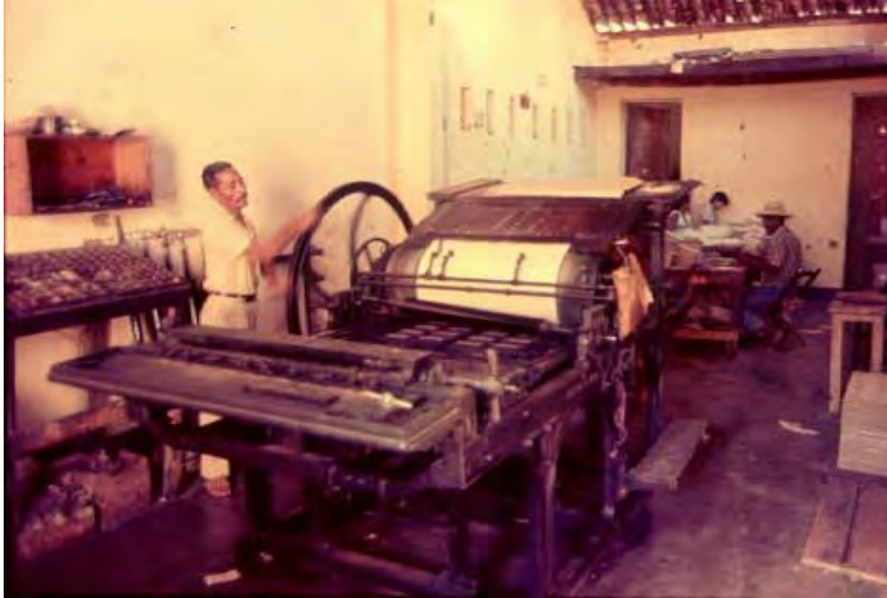
Figura 9: Impressão em máquina movida à mão na Tipografia São Francisco
