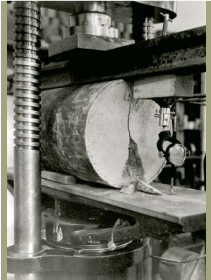
Brazilian Test - Ensaio de compressão diametral de um rolo de concreto, realizado pela Divisão de Materiais de Construção, década de 1940.
