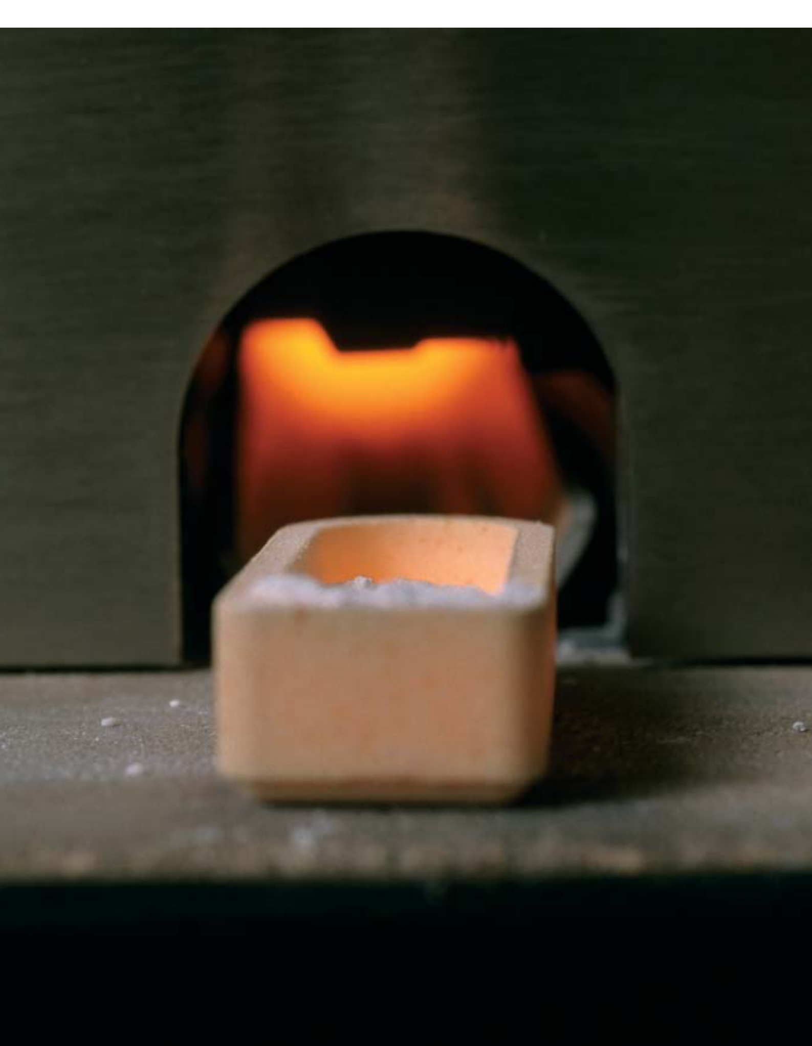
Ensaio de determinação do teor de enxofre no Laboratório de Combustíveis e Lubrificantes, Divisão de Energia.
