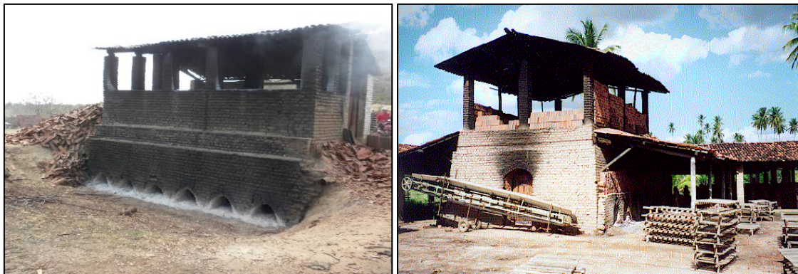
Figura 5 - Fornos caipiras de pequenos produtores, próximo à Santa Rita-PB (produção entre 20 e 25 milheiros de telhas por queima).
