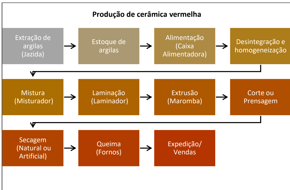
Figura 10 - Fluxograma do processo produtivo. Fonte: elaboração própria.
