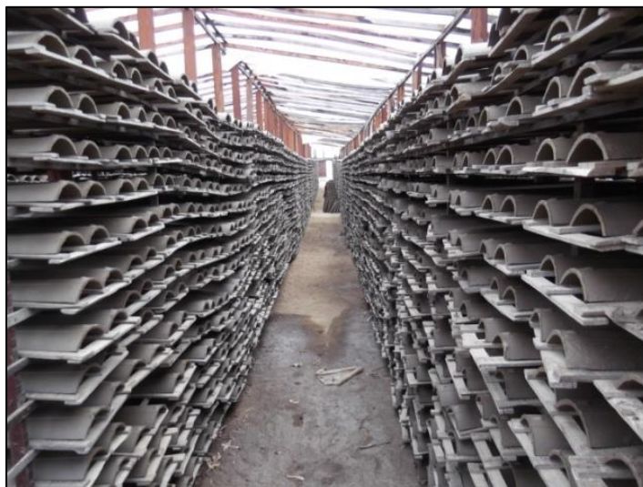
Figura 21 - Secagem em galpão com cobertura plástica.
