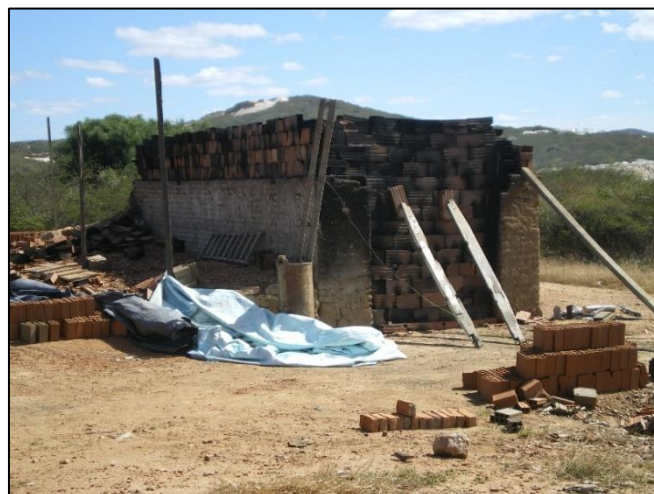
Figura 6 - Forno caieira para a produção de tijolos no município de Equador-RN.
