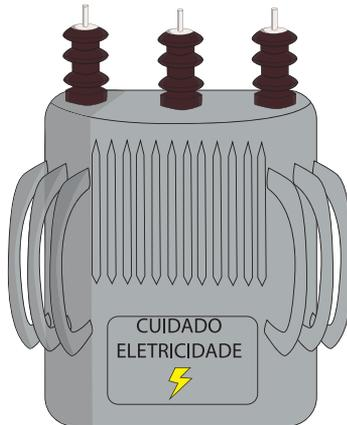
Figura 4. Transformador
