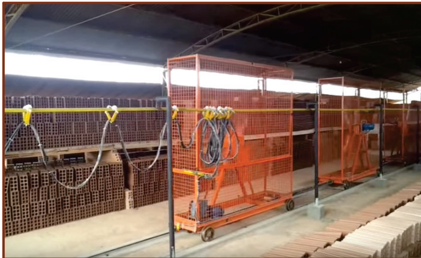
Figura 6 - Sistema autoviajante de secagem
