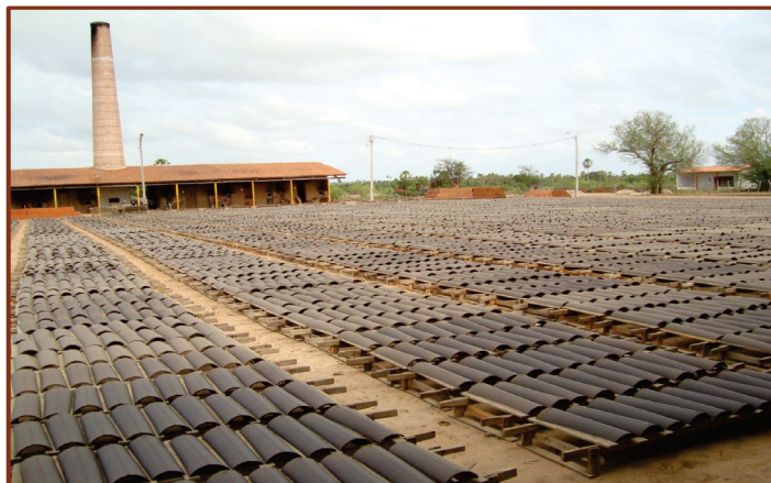
Figura 1 - Secagem natural ao ar livre
