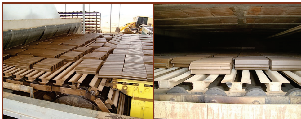
Figura 8 - Funcionamento de um secador tipo talisca
