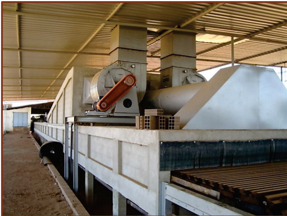
Figura 7 - Secador tipo talisca
