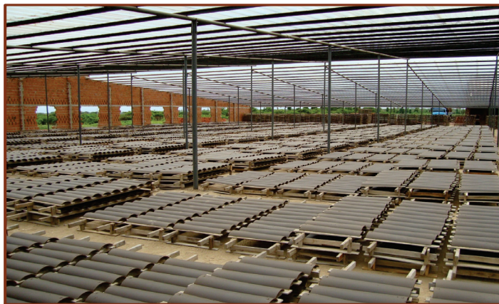
Figura 2 - Secagem natural em estufa
