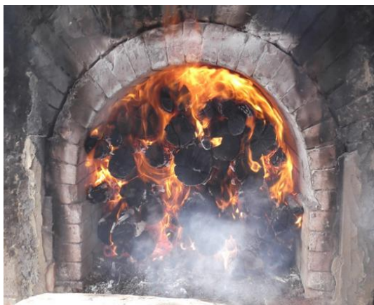
Fornalha com excesso de lenha e pouco ar.
