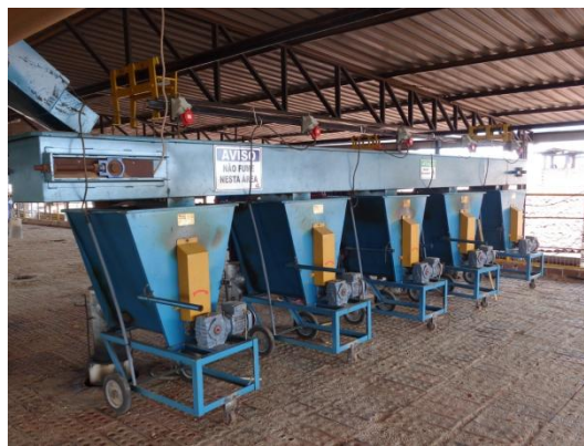
Sistema de caixas alimentadoras de lenha picada em forno câmara
