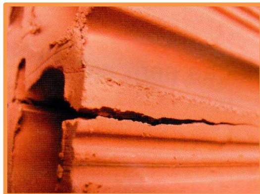
Trincas no formato em “V” típicas de secagem mal feita (Más, E. em Fornos Cerâmicos Um a Um).
