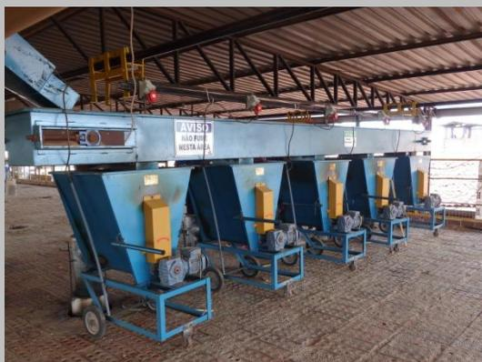
*Sistema de caixas alimentadoras de lenha picada em forno câmara.*
