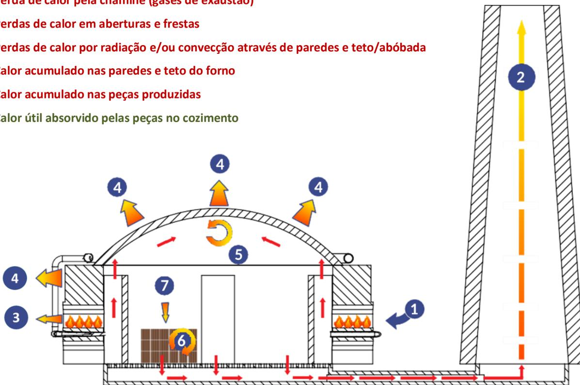
Fluxo de distribuição e de perdas de calor em um forno.
