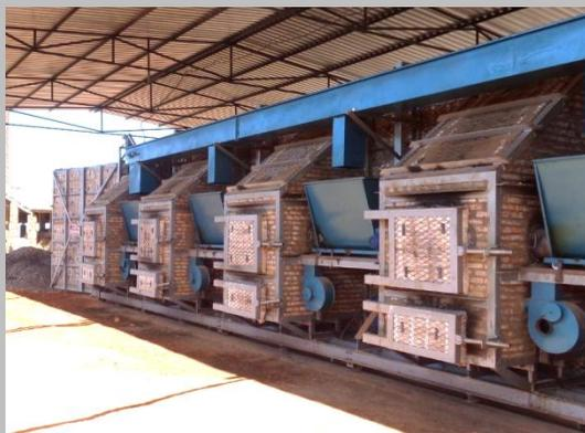
*Sistema de alimentação de cavaco/lenha picada em forno móvel.*
