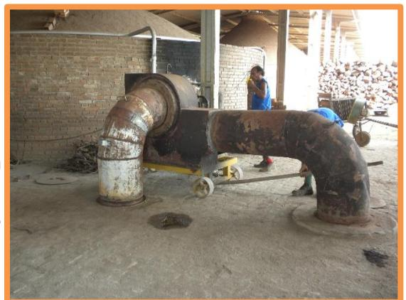
*Dutos auxiliares de recuperação de calor e interligação com canais subterrâneos em forno abóbada (durante a queima).*
