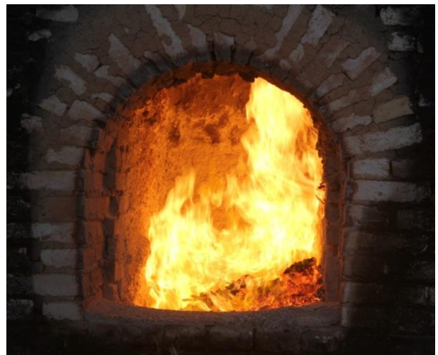
Fornalha com lenha em quantidade adequada aos volumes de ar.
