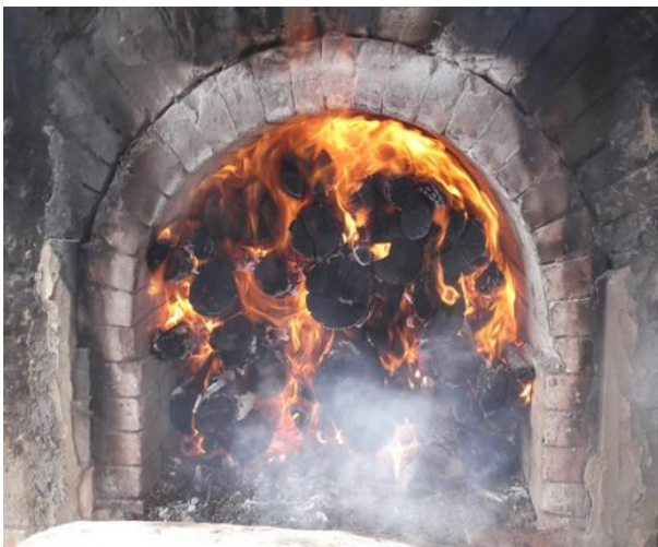
Fornalha com excesso de lenha e pouco ar de combustão.
