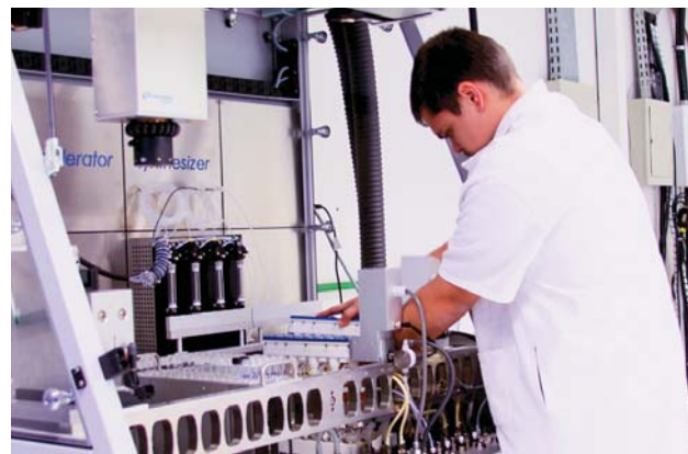
Ensaio realizado no Laboratório de Catálise Combinatorial para síntese e caracterização de catalisadores para novo processos verdes.
