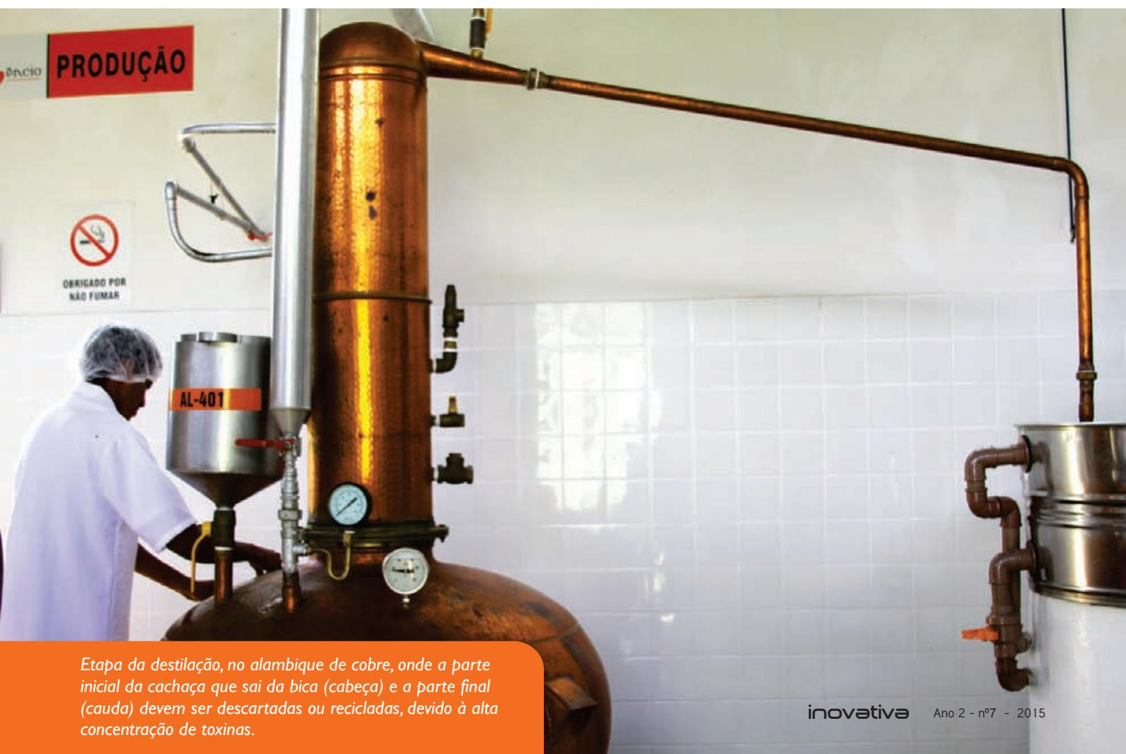
*Etapa da destilação, no alambique de cobre, onde a parte inicial da cachaça que sai da bica (cabeça) e a parte final (cauda) devem ser descartadas ou recicladas, devido à alta concentração de toxinas.*
