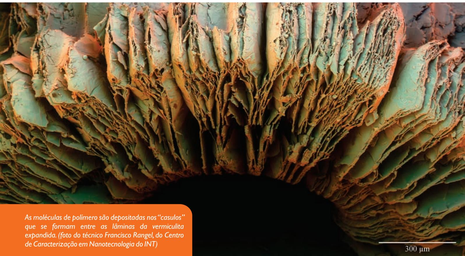
As moléculas de polímero são depositadas nos “casulos” que se formam entre as lâminas da vermiculita expandida. (foto do técnico Francisco Rangel, do Centro de Caracterização em Nanotecnologia do INT)
