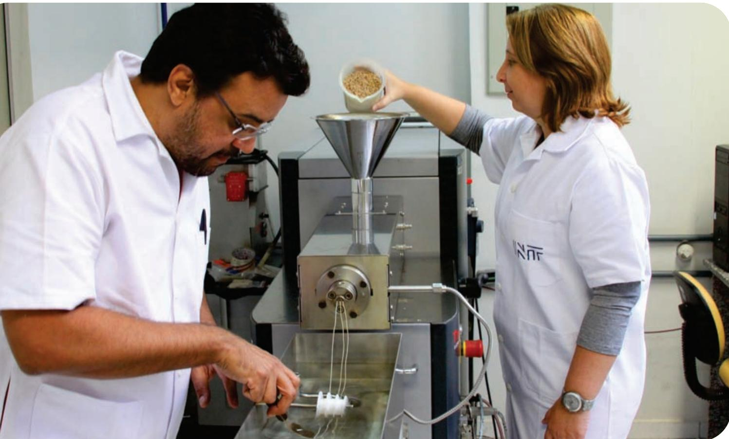
*No Laboratório de Materiais Poliméricos do INT, o químico Marcelo Leão de Oliveira acompanha a saída dos filamentos de nanocompósito da máquina extrusora alimentada com a mistura de poliéster e vermiculita pela engenheira química Márcia Gomes de Oliveira.*
