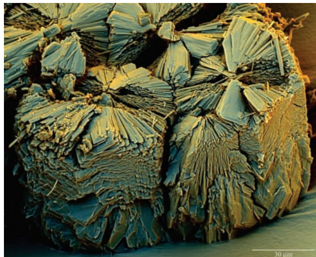
Camadas de óxido de ferro em aço, usadas em pesquisas da área de Corrosão, ganhadora do prêmio mensal Fei Image de abril de 2014.
