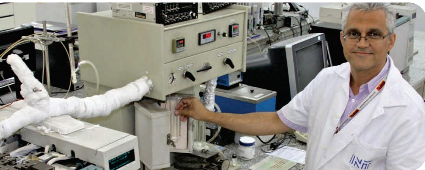
No Laboratório de Catálise do INT, o pesquisador Fábio Bellot coloca o catalisador dentro do reator onde o gás metano é convertido em hidrogênio, com os resultados demonstrados pelo cromatógrafo ligado ao sistema.
