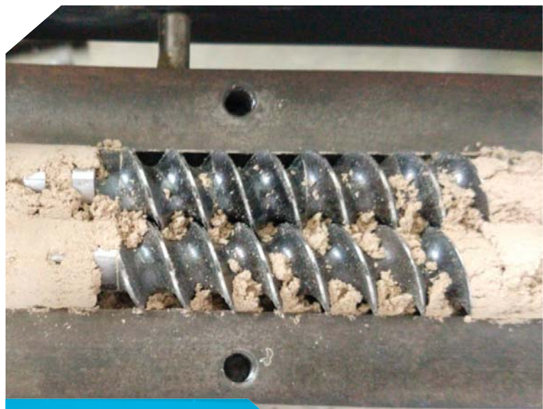
Detalhe do mecanismo da extrusora, que comprime e aquece a biomassa, modificando suas propriedades.
