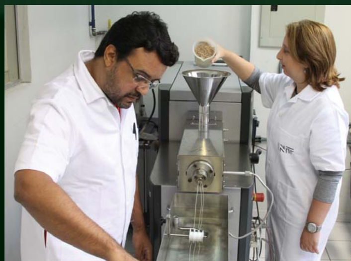
No Laboratório de Materiais Poliméricos do INT, pesquisadores usam máquina extrusora para produzir plástico nanocomposto biodegradável.
