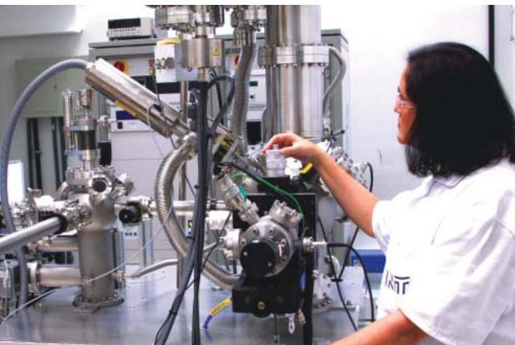
No Cenano, pesquisadora do INT opera o XPS (espectrômetro de fotoelétrons por raios-X) para examinar superfícies em dimensões nanométricas.
