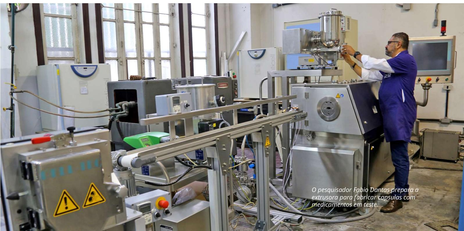
O pesquisador Fabio Dantas prepara a extrusora para fabricar capsulas com medicamentos em teste.
