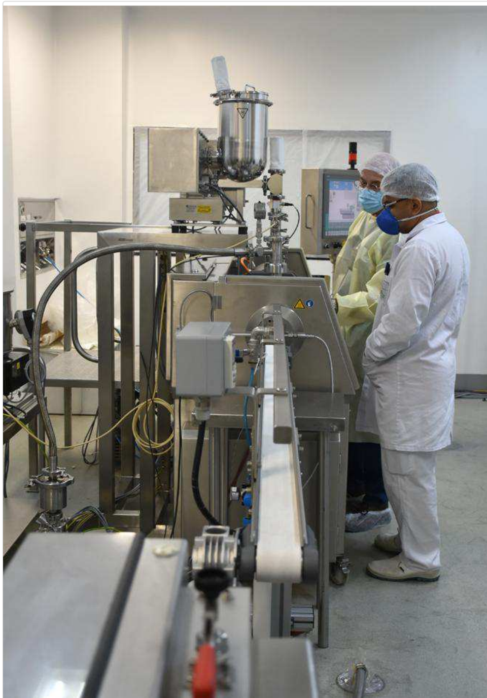
Ao sair da extrusora, o material fundido e totalmente misturado sofre um resfriamento na esteira fria, o que possibilita manter a forma mais estável (Alexandre Matos)
