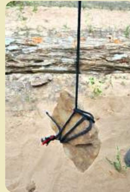
Para checar se o nível está bem ajustado, devemos dar uma volta no pé de galinha, sobre as estacas. Com a volta, comprova-se que o prumo segue marcando nível exato, ou seja, que o cordão segue passando justo pela marca
