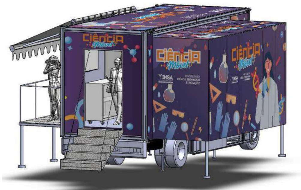
Figura 12. Vista externa traseira do veículo Ciência Móvel, com lateral expansível e porta aviônica.
