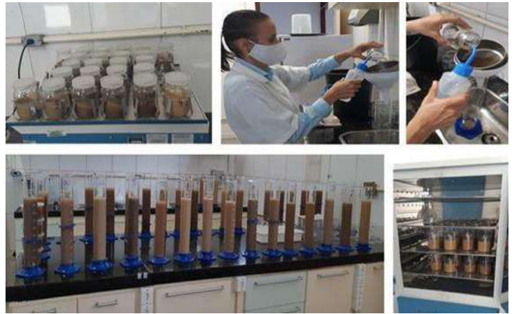
Figura 10. Realização da análise de fracionamento físico da matéria orgânica dos solos de referência em área de reserva da EE do INSA.
