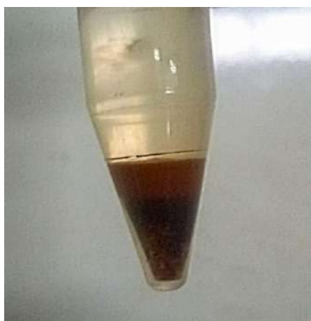
Figura 3. Fracionamento químico do P. Na etapa de extração com \text{NaOH} 0,5 \text{ mol L}^{-1} é possível visualizar a separação da fase mineral e orgânica do solo. Neste extrato é determinado os teores de P orgânico e P inorgânico. Fonte: Autores.
