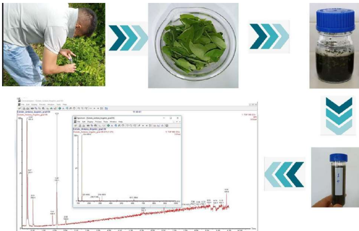
Figura 10. Coleta, extração e análise do índigo por HPLC-QTOF.
