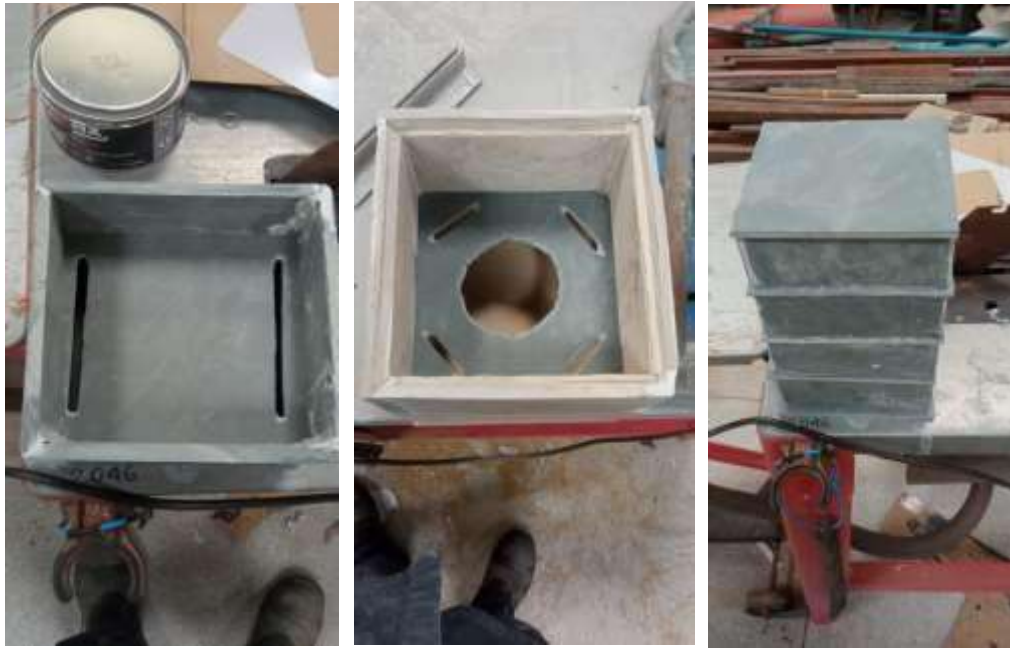
Figura 13. Caixas para melíponas construídas com pedra ardósia, contendo ninho e melgueira
