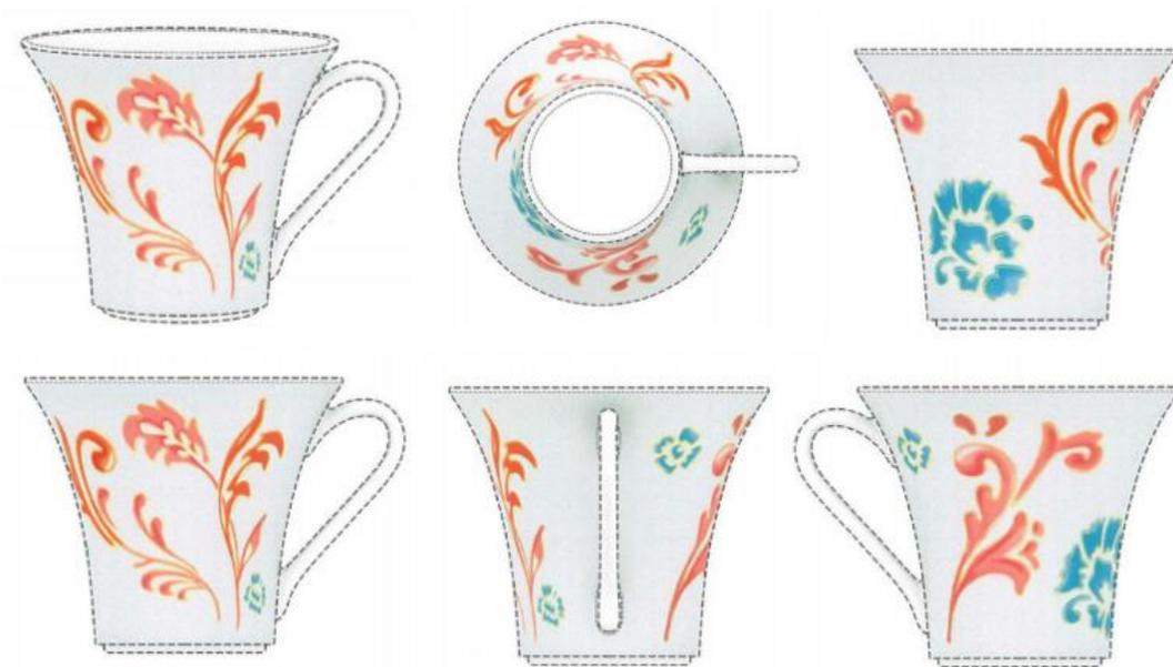
Ejemplo de ornamento aplicado a un producto tridimensional en el que se requieren seis vistas para la reivindicación completa del diseño industrial del ornamento (DI7102778)
