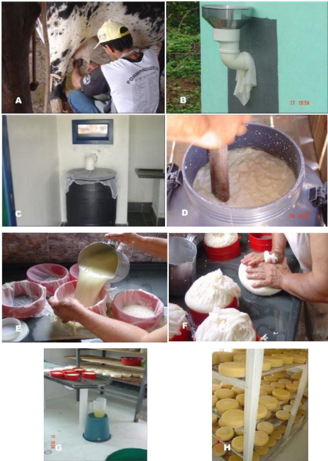
Figura 47: Principais etapas do processo de fabricação do queijo da Canastra. A: Ordenha; B: Filtro externo à queijaria; C: Filtro interno à queijaria; D: Corte da Massa; E: Enformagem; F: Prensagem; G: Coleta do “pingo” H: Maturação Fonte: DORES (2007)
