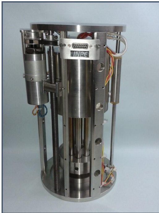
Experimentos de solidificação de ligas semicondutoras em ambiente de microgravidade, desenvolvidos no LAS/CTE. Detalhe do dispositivo para até três experimentos, à esquerda, e sistema instalado no foguete VSB30 para lançamento, à direita
