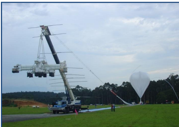
Experimento SUMIT (telescópio de raios-X com 1.270kg) da Universidade de Nagoya e ISAS. O lançamento foi realizado em Cachoeira Paulista
