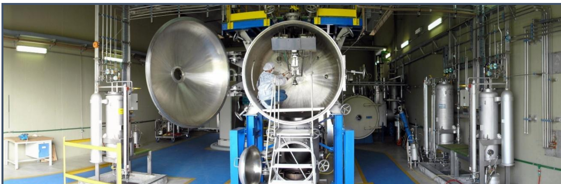
Propulsor químico de 200N montado na câmara de vácuo principal do Banco de Testes com Simulação de Altitude – BTSA, no LCP/CTE
