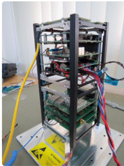
Figura 2: Integração do Transponder com o modelo 2U
